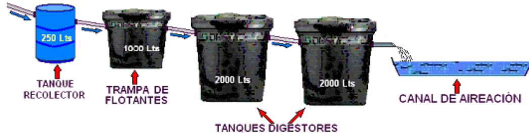
FIGURA 3. PERFIL HIDRÁULICO DEL SISTEMA DE TRATAMIENTO
