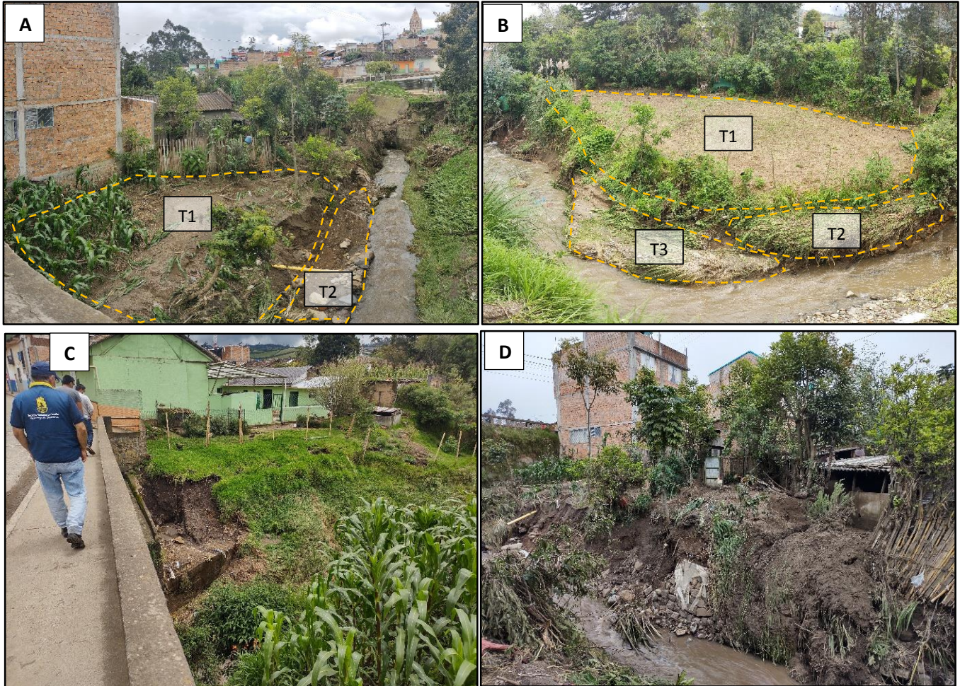
Figura 4. A – B. Formación de terrazas de acumulación por acción de la quebrada Granadillo– Barrio Pueblo Nuevo. C – D deslizamientos taludes partes posterior viviendas Barrio Pueblo Nuevo.
