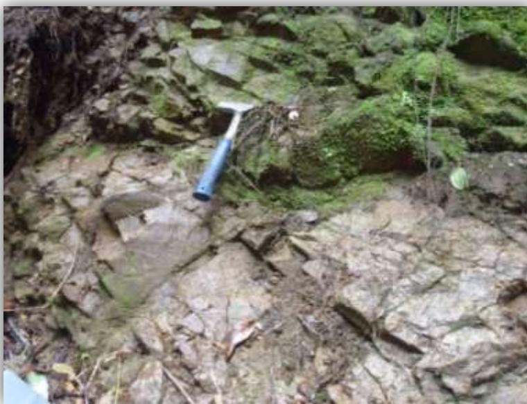
Figura 2. Gneis grisáceo quebrada El Motilón, altamente diaclasado.
