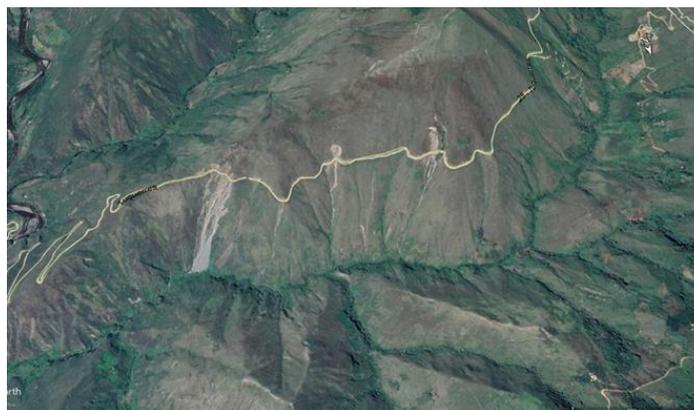
**Figura 241. Deslizamientos vía Sotomayor.**
