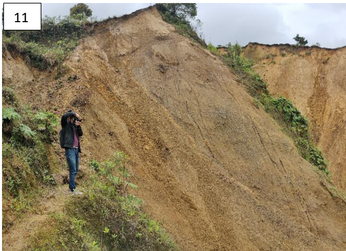
Imagen 11. Tomada del informe técnico 062/21. Imagen 12. Fotografía comparativa, tomada el día 02 de abril de 2022, se evidencia el deslizamiento activo, suelo saturado, escorrentía superficial y formación de surcos.
