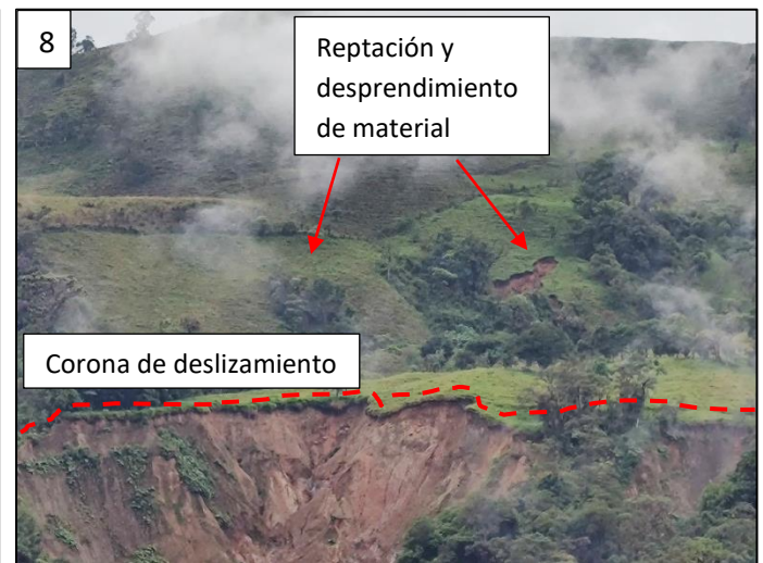
Imagen 7. Deslizamiento rotacional con flujo de detritos. Imagen 8. Evidencia de reptación y desprendimiento de material.
