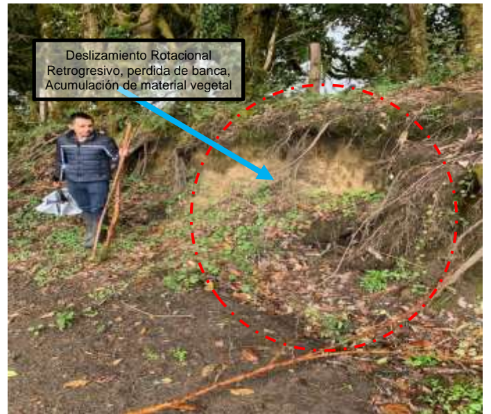
Zona donde se evidencia, Agrietamiento profundo se observa deslizamientos Rotacionales, Pérdida de banca, Acumulación de material vegetal en el Cerro Chimayoy.
