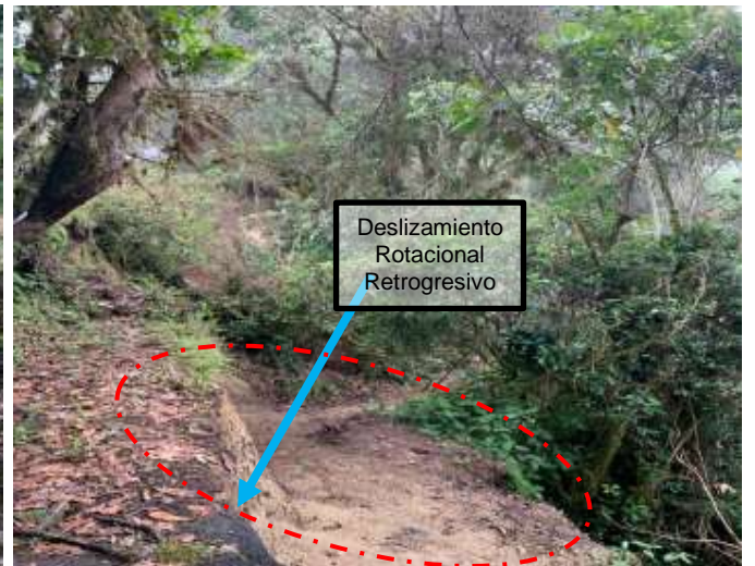
Zona donde se evidencia, Agrietamiento profundo se observa deslizamientos Rotacionales, Filtración de agua, en el Cerro Chimayoy.
