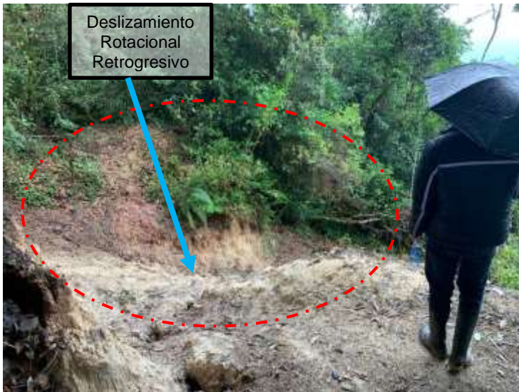
Zona donde se evidencia Deslizamiento Rotacional Retrogresivo en el Cerro Chimayoy.
