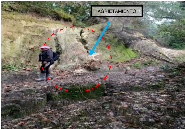
Zona donde se evidencia, Agrietamiento profundo se observa deslizamientos Rotacionales, Filtración de agua, en el Cerro Chimayoy.
