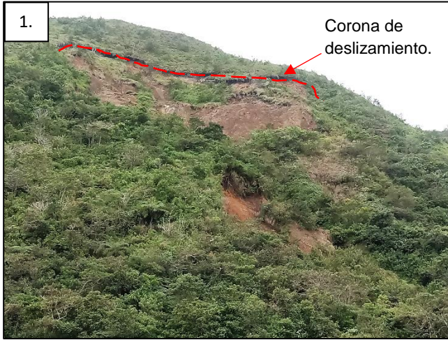
Imagen 1 y 2. Parte alta, deslizamiento rotacional.
