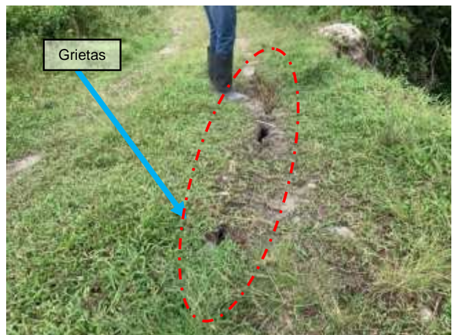
zona que presenta, Deslizamiento rotacional retrogresivo, Grietas
