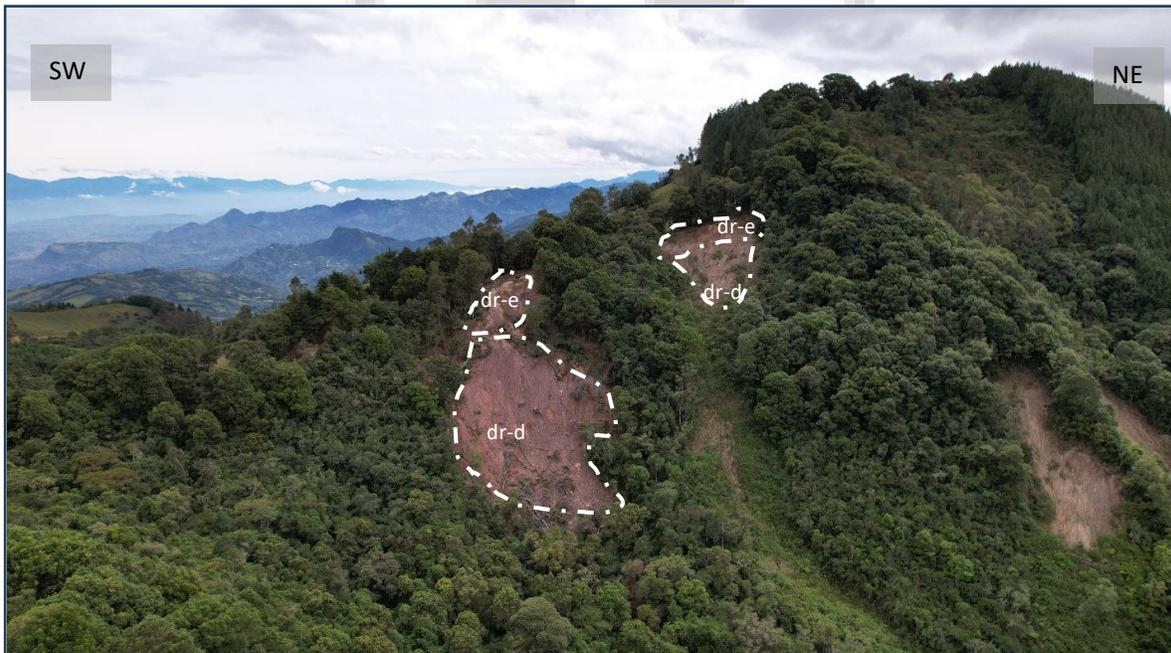
**Figura 41 Deslizamientos bajo la divisoria, sobre ladera erosiva. ESTACIÓN KNK0010, KNK0011**
