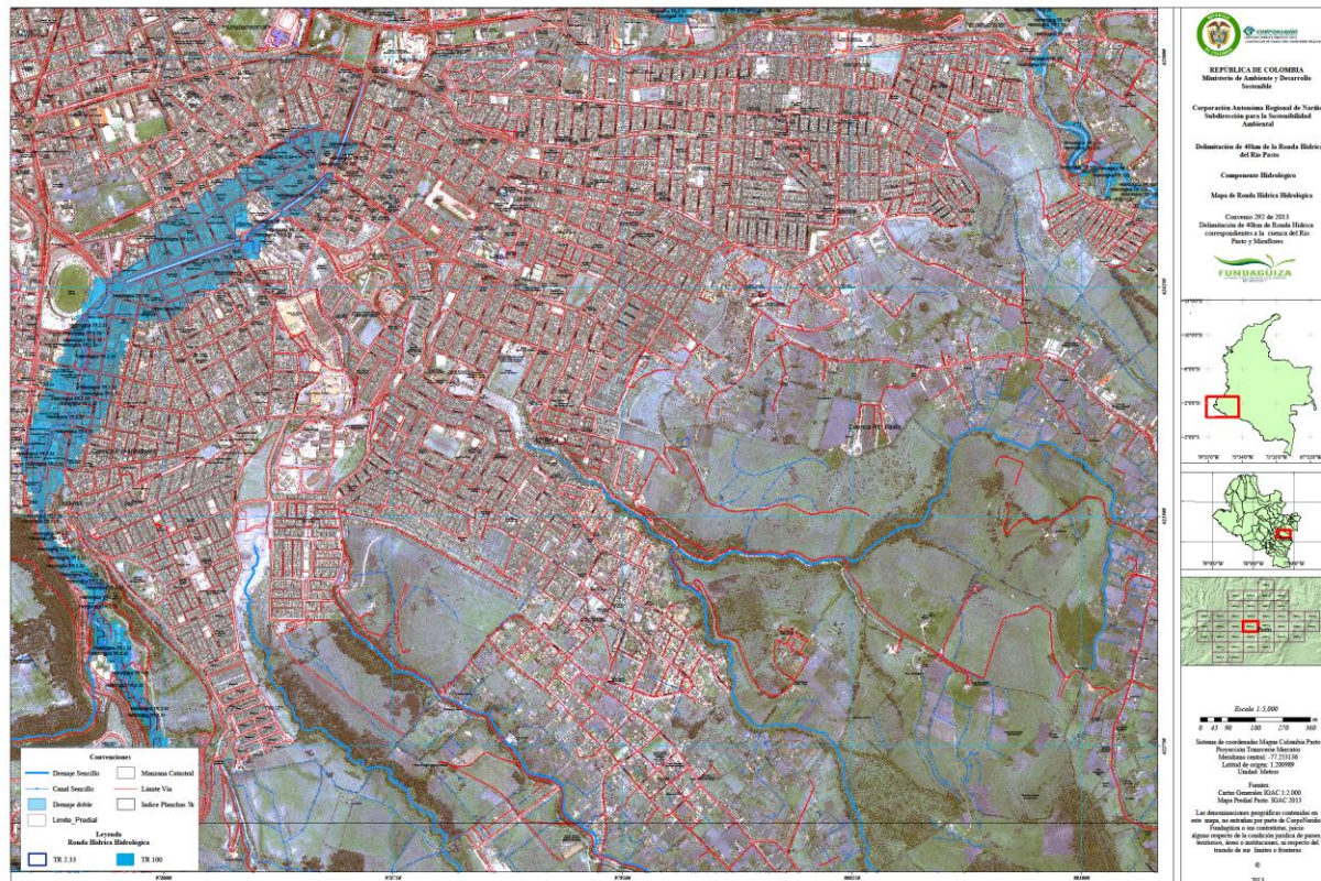
Figura 45. Ronda Hídrica río Miraflores, sector avenida Chile con tiempo de retorno a 15-100 años.
