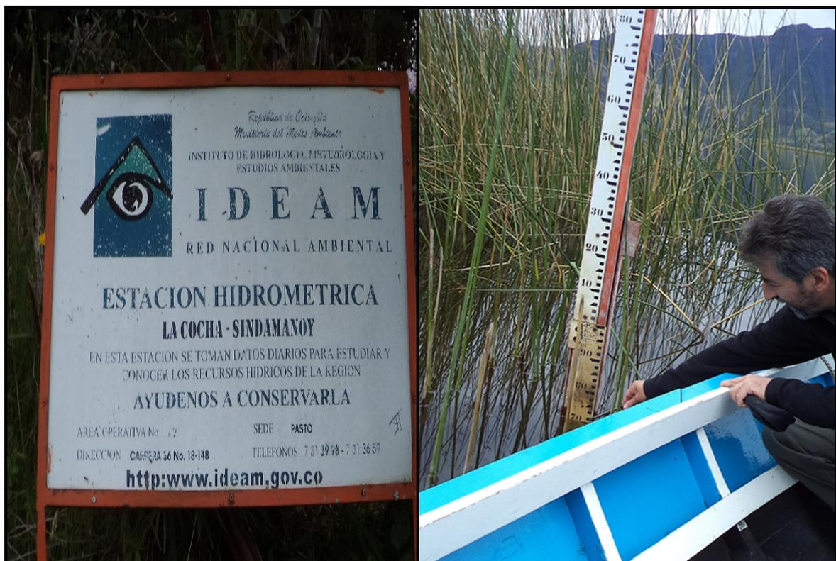
Figura 5-1: Estación limnimétrica Sindamanoy
