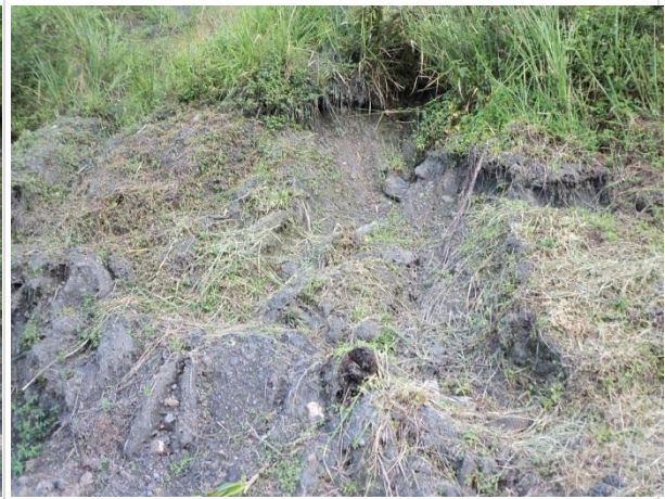
Fotografía 25 y 26. Panorámica en dirección SE-NW. EVENTO 14. La altura del evento es de 5.0 m. se desarrolla longitudinalmente en 61.0 m. El movimiento corresponde a una masa de 241.0 m 3 , ocupa un área de 366.0 m 2 .
