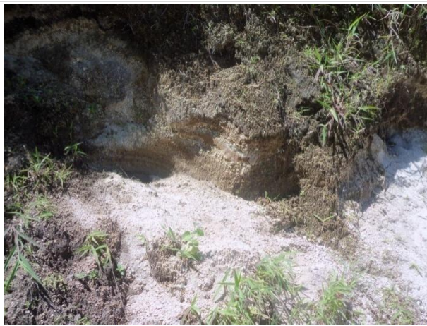
Fotografía 41. EVENTO 04. Detalle de la presencia de un estrato de arena limosa, color carmelita y blanco en la base del evento.
