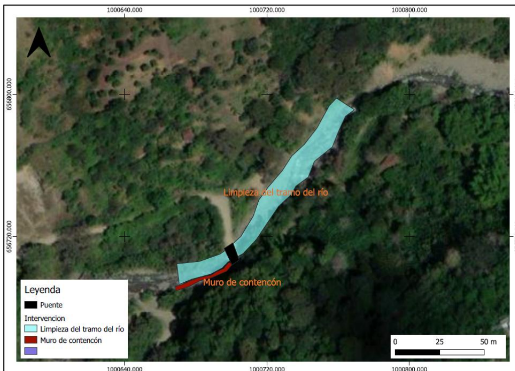
Figura 8. Medidas de intervención propuestas.
