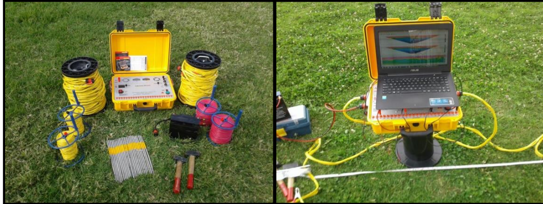
Figura 11. Equipo de adquisición de datos de resistividad eléctrica. Subreme DC600
