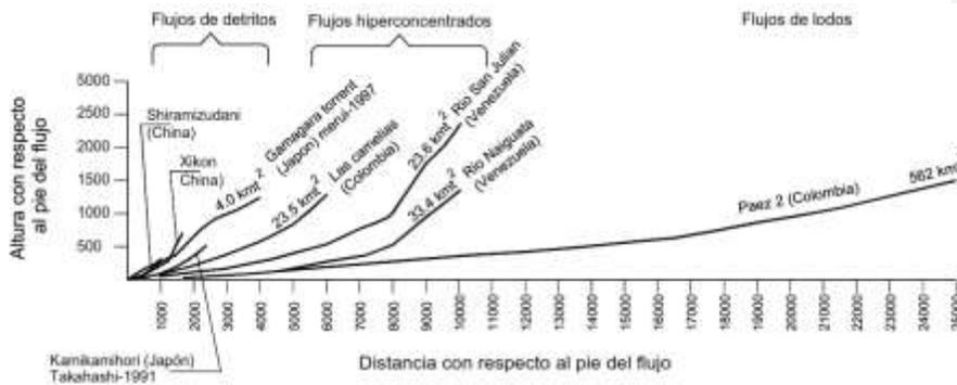
**Figura 3.** Perfiles longitudinales del canal para diferentes tipos de flujo (Suárez , Control de erosión en zonas tropicales, 2001).
