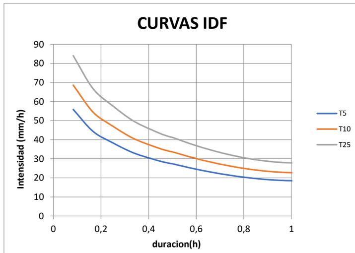
Figura 24. Curvas IDF sin ajuste para la microfrecuencia Cumac.
