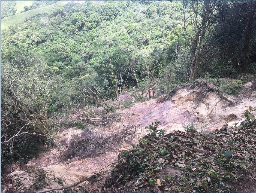
Figura 13 Materiales arenosos y limoso producto de la meteorización de la Fm. Esmita PUNTO KNK009. COORDENADAS CTM12 X: 4546765, Y: 1730324.
