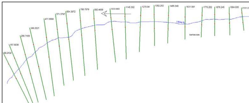
Figura 136. Seccionamiento río Telembí tramo urbano del municipio de Barbacoas.
