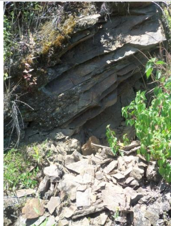
Fotografía 45. Afloramiento de esquistos verdes, de estructura foliada, y alto grado de meteorización. Localizados en la ladera Este, a una altura de 2.053 msnm.
