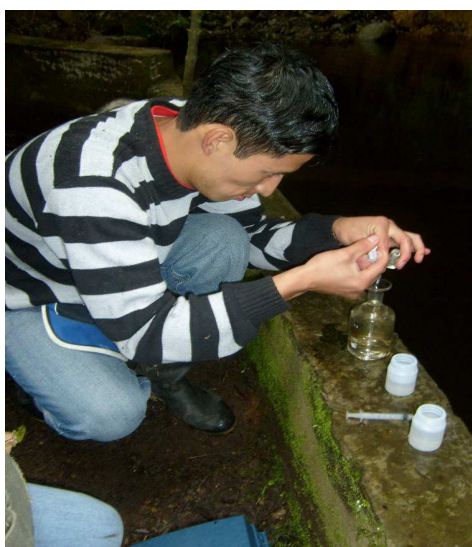
Figura 5. Toma de prueba de oxígeno disuelto.
