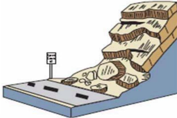
Figura 17. Esquema de caídas de roca, (Tomado de USGS, 2004).
