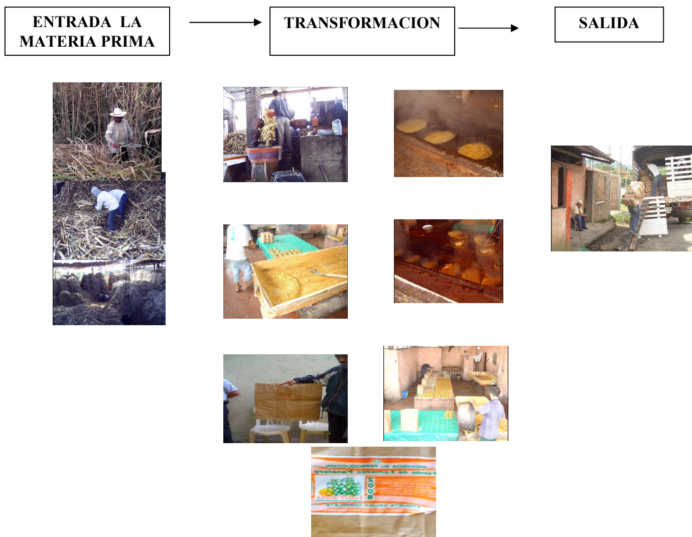
Figura 13 Proceso de elaboración de la Panela
