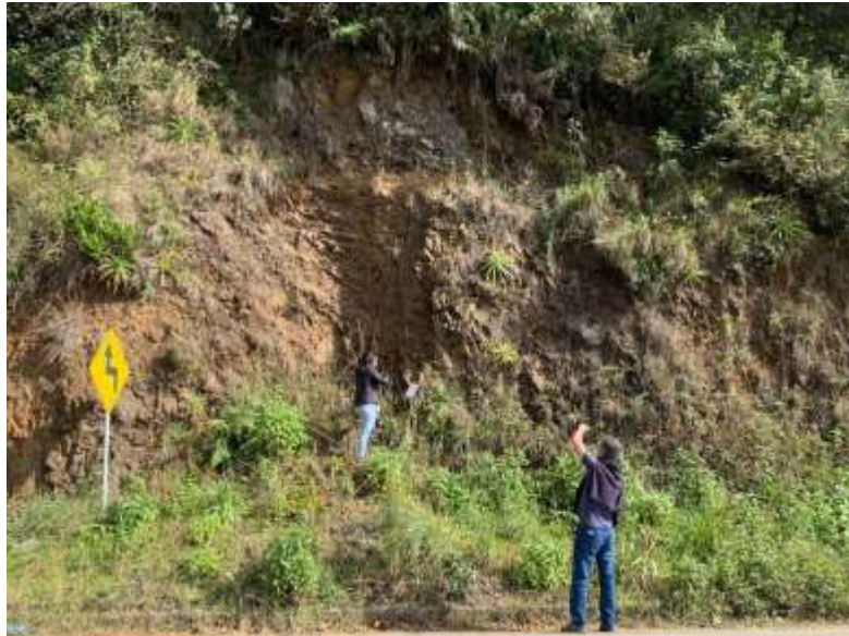
Punto 7. Control litológico, rocas altamente fracturadas, evidencia de cizalla y de zonas de falla.
