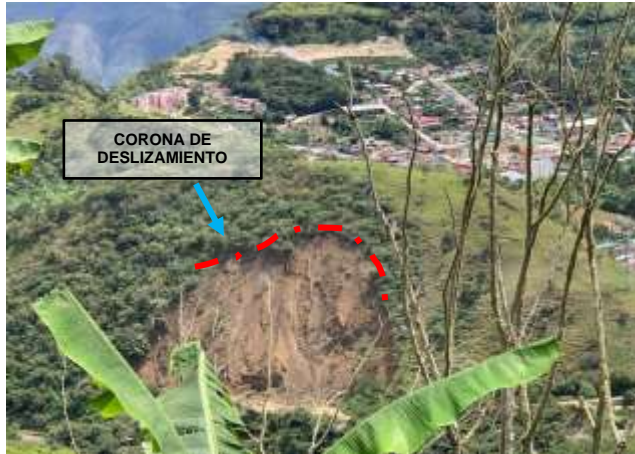
Figura 2. A. Deslizamiento Rotacional (Punto 9) B. Deslizamientos rotacionales (Punto 10) C. Deslizamiento rotacional (Cantera antigua) (Punto 11) D. Terraceo, Casco urbano El Peñol (Zona de falla). (Punto 12).
