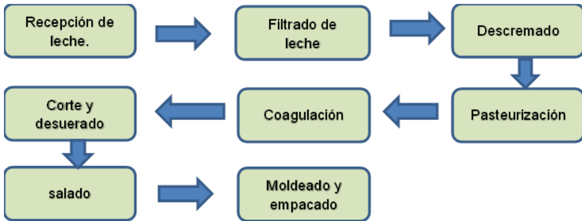
Figura 1. Diagrama de procesos en el procesamiento lácteo
