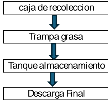
Figura 3. Esquema de tratamiento ARnD San Diego
